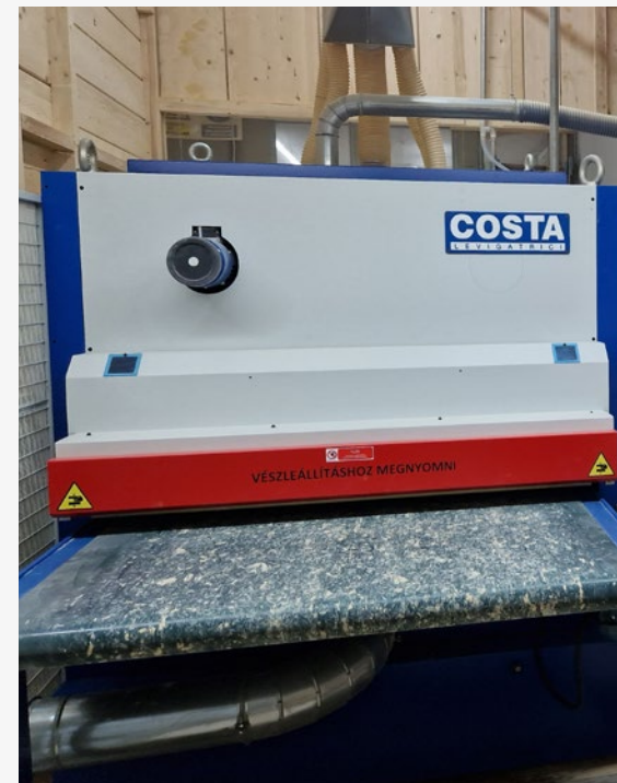
▼ Maschine zum Schleifen der Holzplatten.
